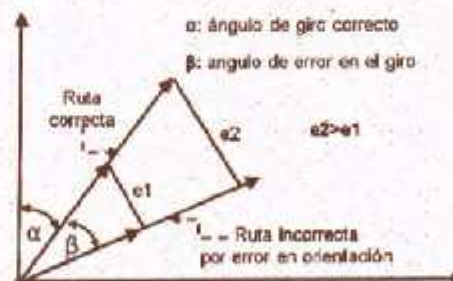
Fig. 2 Error de orientación en el cálculo de localización
