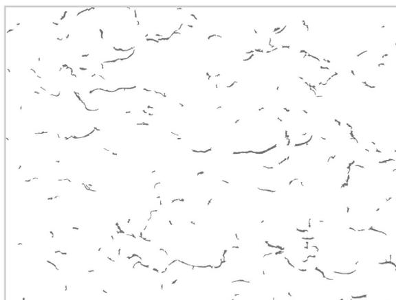
**Figura 12.** Tratamiento digital de imágenes para revelar grietas en probeta a 64 ciclos, 500x.
