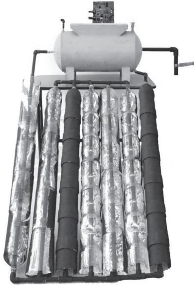
**Figura 6.** Calentador solar – Prototipo inicial. Construcción propia.
