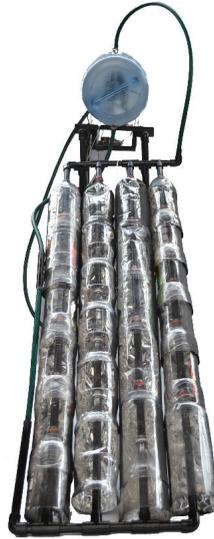
**Figura 9.** Calentador solar – Prototipo final. Construcción propia
