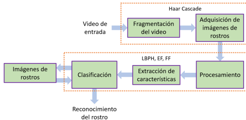
Fig. 2. Diagrama de bloques del sistema de reconocimiento de rostros propuesto
