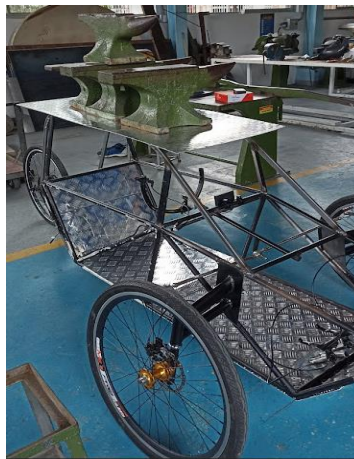
Fig. 22. Prueba de carga estática Superior y sistema de dirección Furtivo 01 (Elaboración Propia)
