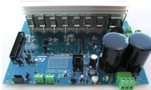
Fig. 4. Módulo de prototipado y desarrollo de inversores de voltaje polifásico.
