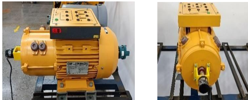
Figura 6: Sistema para la adquisición temperatura en el estator del motor.
