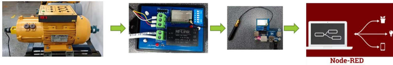
Figura 7: Sistema para la adquisición velocidad angular del rotor.
