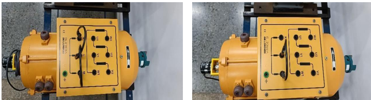
Figura 9. Motor de rotor devanado en operación normal (izquierda), y con falla en el rotor (derecha).
