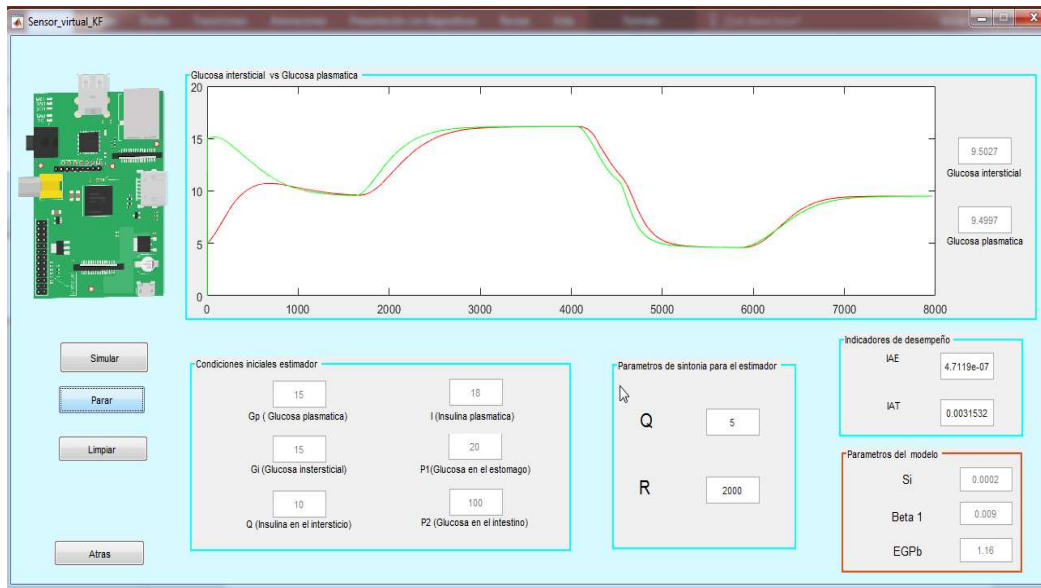
Figura 37. Simulación del KF utilizando la técnica HIL.
