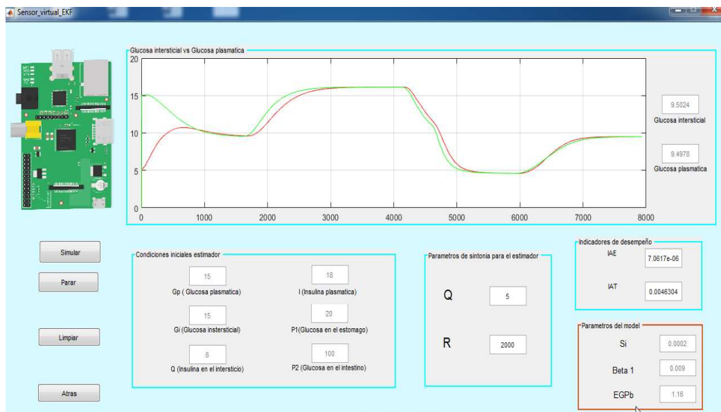
Figura 38. Simulación del EKF utilizando la técnica HIL.
