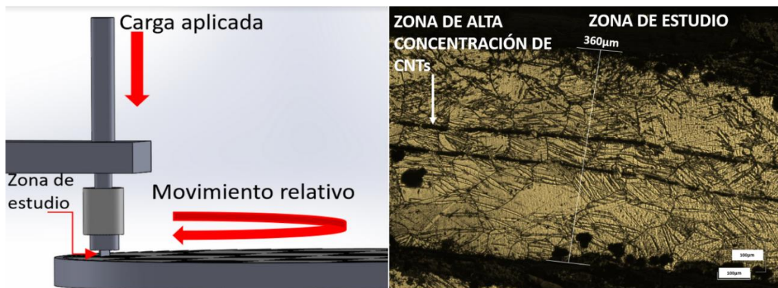
Figura 2. a) Esquema de ensayos tribológicos Pin-On-Disk y b) imagen óptica de muestras preparadas para los ensayos tribológicos (revelado de su microestructura con picral)
